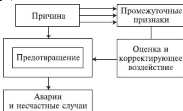
Рисунок 1 – Методика использования промежуточных признаков для предотвращения происшествий
